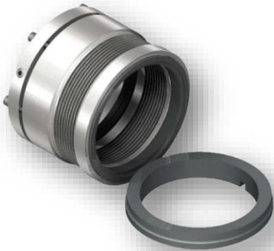
Sello mecánico de fuelle metálico diseñado para soportar altas temperaturas de hasta 425°C con guías debajo del fuelle metálico que le dan tracción adicional. De aplicación típica en soluciones acuosas para la industria del proceso a altas temperaturas, solventes como el tolueno o benceno, cáusticos, hidrocarburos, fluidos lubricantes y fluidos utilizados para la transmisión de calor. Su diseño es libre de elastómeros.
