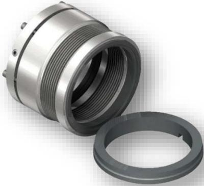
Sello mecánico de fuelle metálico diseñado para soportar altas temperaturas de hasta 425°C de sección angosta para ajuste sencillo. De aplicación típica en soluciones acuosas para la industria del proceso a altas temperaturas, solventes como el tolueno o benceno, cáusticos, hidrocarburos, fluidos lubricantes y fluidos utilizados para la transmisión de calor. Su diseño es libre de elastómeros.
