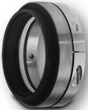
Para uso en bombas que manejan fluidos corrosivos y otros servicios. Ningún componente metálico está en contacto con el fluido. Sello balanceado, no requiere escalones en el eje para trabajar en presiones hasta 21 bar. Ideal para bombas con cajas de poca profundidad. Pre-ensamblado, se desliza sobre el eje hasta que ajuste contra la estacionaria tipo "L", se aprietan los opresores, se remueven las grapas de retención y ¡LISTO PARA USARSE !
